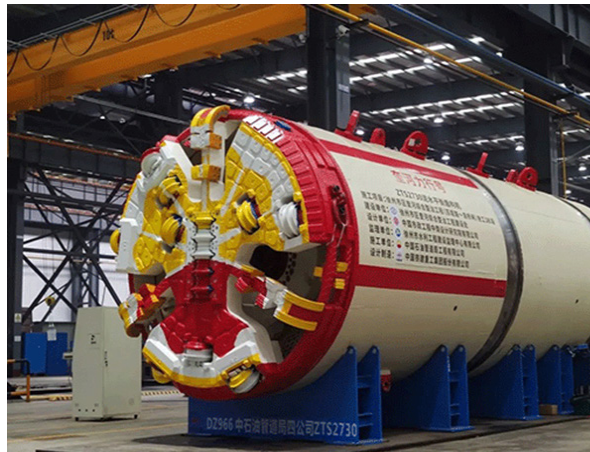
国产最小直径泥水平衡盾构机“奎河力行号”
