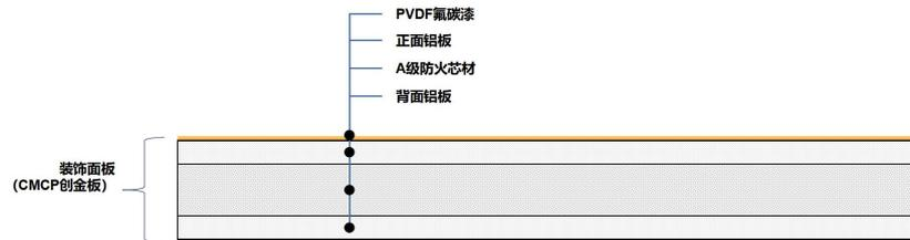
图3：装饰面板-A级防火铝复合板示意图
